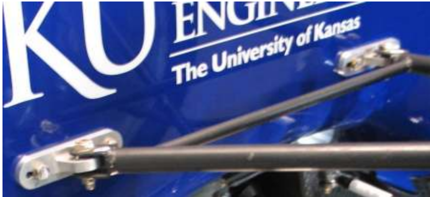
Metal Tabs Bolted to Chassis (KU)
