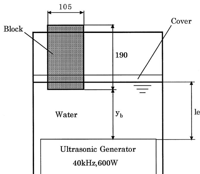
Fig. 1 Experimental apparatus.
